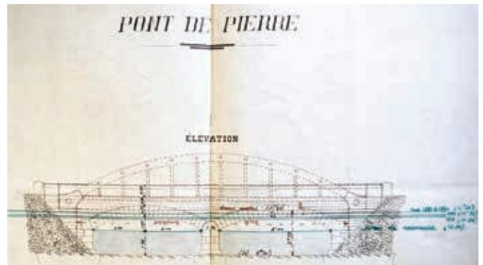
Une amélioration sensible serait apportée à l'écoulement en temps de crue par le remplacement du pont actuel par un pont en béton armé de 20m d'ouverture, dont le dessous des poutres serait à 0m 20 au-dessus des plus hautes eaux connues (voir dessin).
