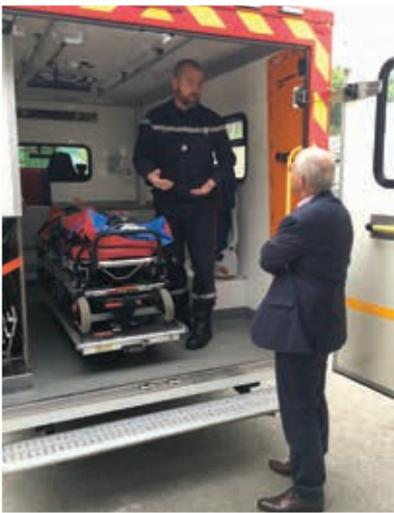
Le centre opérationnel de Jouy s'est doté d'un VSAV (Véhicule de Secours et d'Aide aux Victimes), unique en son genre, puisqu'il est le seul dans le département à être pourvu d'un brancard à manègement électrique permettant de transporter des personnes de très fortes corpulences.
